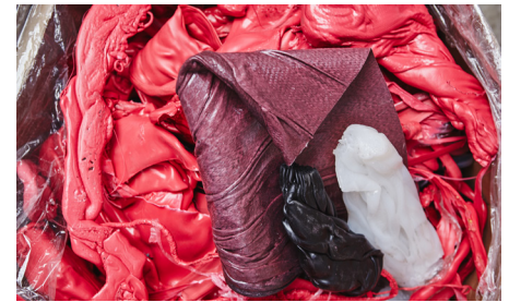
Vtoky, odstříky Inlets, splashes
